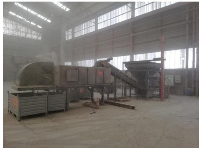
Figure 15 : Machines des postes de reprise pour le tri densimétrique (à gauche) et le tri par courant de Foucault (à droite)
