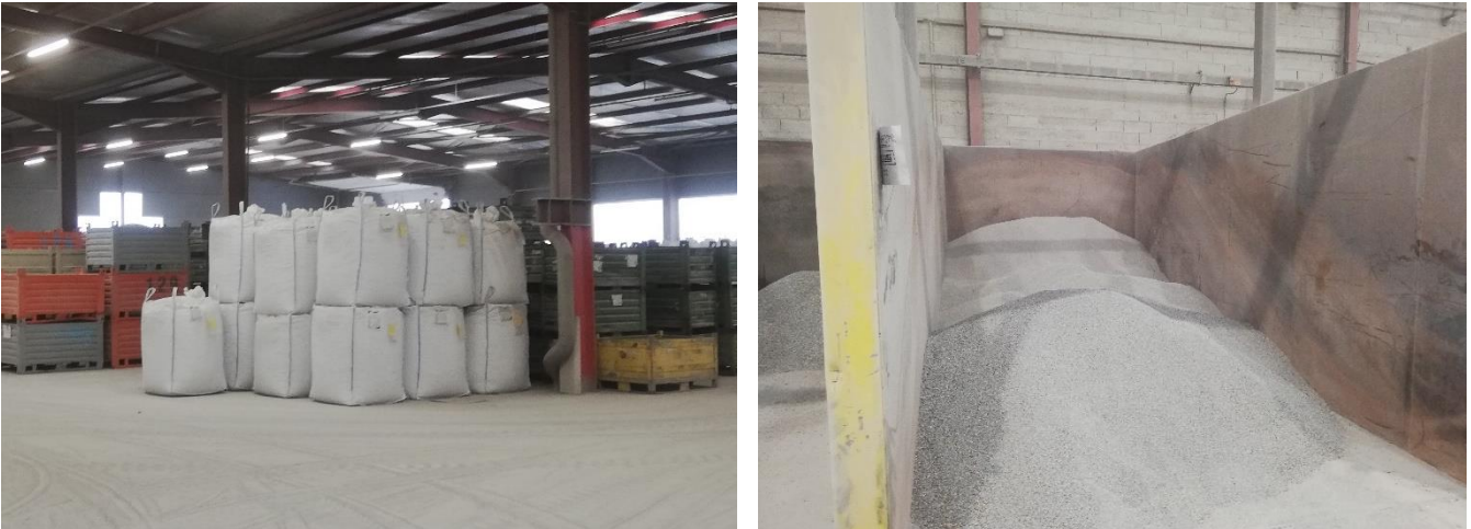
Figure 8 : Métaux et ultrafines conditionnés en big bag (à gauche) et fraction minérale en vrac (à droite)
