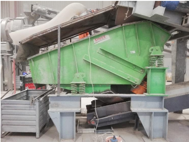
Figure 11 : Machine de criblage des fractions supérieures à 50 mm (à gauche) et fractions supérieures à 50 mm (à droite)
